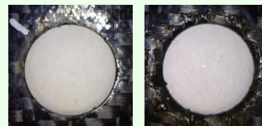
CFRP（厚み2mm） マトリックス:ポリウレタン カーボン45%綾織り
