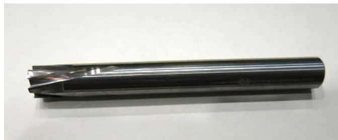
試作開発した工具の外観 (全長:100mm, 直径:12mm)
